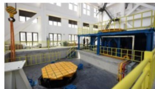
双六自由度仿真试验平台
